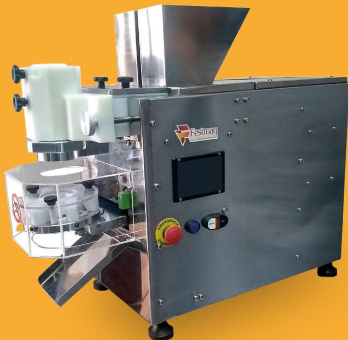
A modeladora Potenza produz salgados e doces, de 7g a 180g, com capacidade de até 10.000 unidades por hora (7g a 10g), ideal para quem trabalha com grandes produções, tendo a possibilidade de adquirir a máquina em Duplo Recheio ou Recheio Simples.
