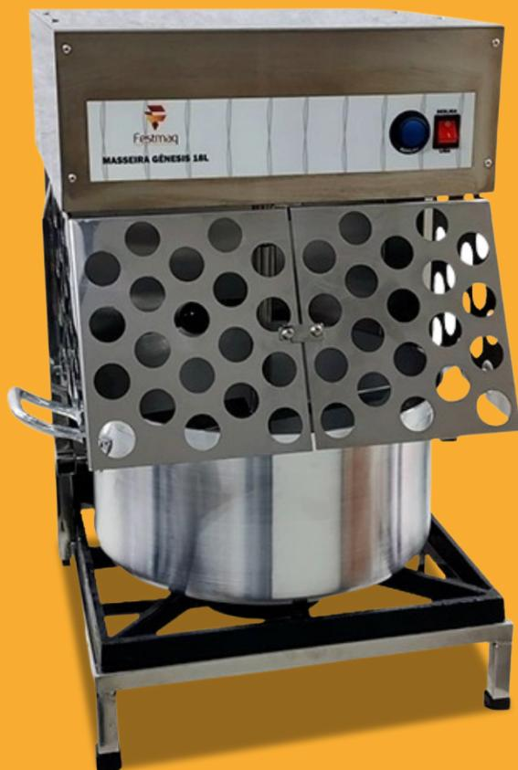
A masseira Gênesis 23 litros é uma máquina fabricada com a **estrutura em aço inox**, projetada para retenção de calor, trazendo economia no consumo de gás. Além disso, possui caçarola em alumínio feita no sistema de repuxo, que mantém os poros fechados no processo de fabricação, evitando a transferência de sabores entre os produtos.
