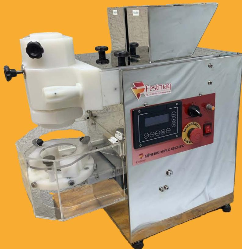
A modeladora produz salgados e doces com recheio simples, de **7g a 180g**, com capacidade de até **5.000 unidades por hora (de 7g a 10g)**. Além disso, existe a possibilidade de acoplar um funil na máquina, tornando-a uma modeladora Duplo Recheio.
